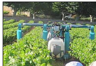
L'utilisation de panneaux récupérateurs permet une économie substantielle de produits de traitement et évite sa dispersion.
