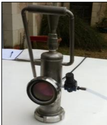
Le soufre se consume dans la chambre du générateur. Le dioxyde de soufre est canalisé dans un tuyau et émis par un microdiffuseur au cœur de la cuve.
