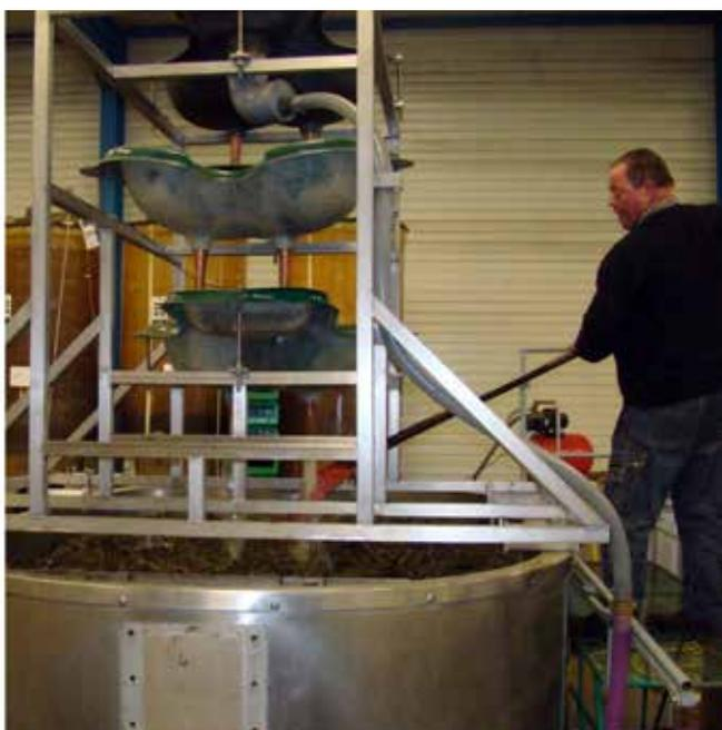
Remplissage de cuves avec l'eau de pluie avec Dynam'O (trois vasques) sur cuves pour tisanes et macérations.
