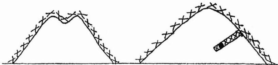
Tas avec sillon de faitage pour arrosage si le refroidissement est nécessaire
